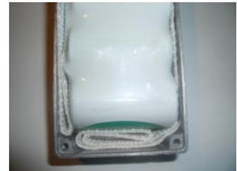
11. Rückwand (2) auf Gehäuse (1) aufschrauben
